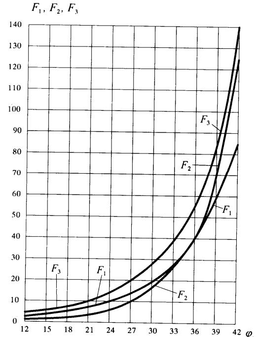
**Рисунок 6.12 — Графики определения коэффициентов  $F_1$ ,  $F_2$  и  $F_3$  для расчета несущей способности оснований в условиях сейсмических воздействий**
