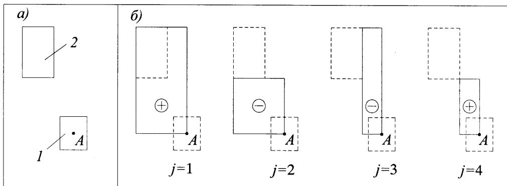
*a* — схема расположения рассчитываемого  $I$  и влияющего фундамента  $2$ ; *б* — схема расположения фиктивных фундаментов с указанием знака напряжений  $\sigma_{zp,j}$  в формуле (5.21) под углом  $j$ -го фундамента.
