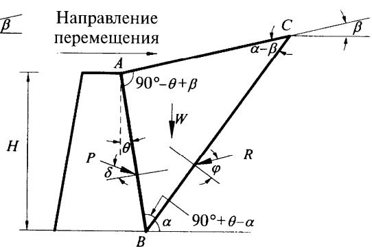
**Рисунок 9.2 — Схема к определению величин активного (а), пассивного (б) давления грунта при негоризонтальной поверхности грунта и наклоне граней конструкции к вертикалам**
