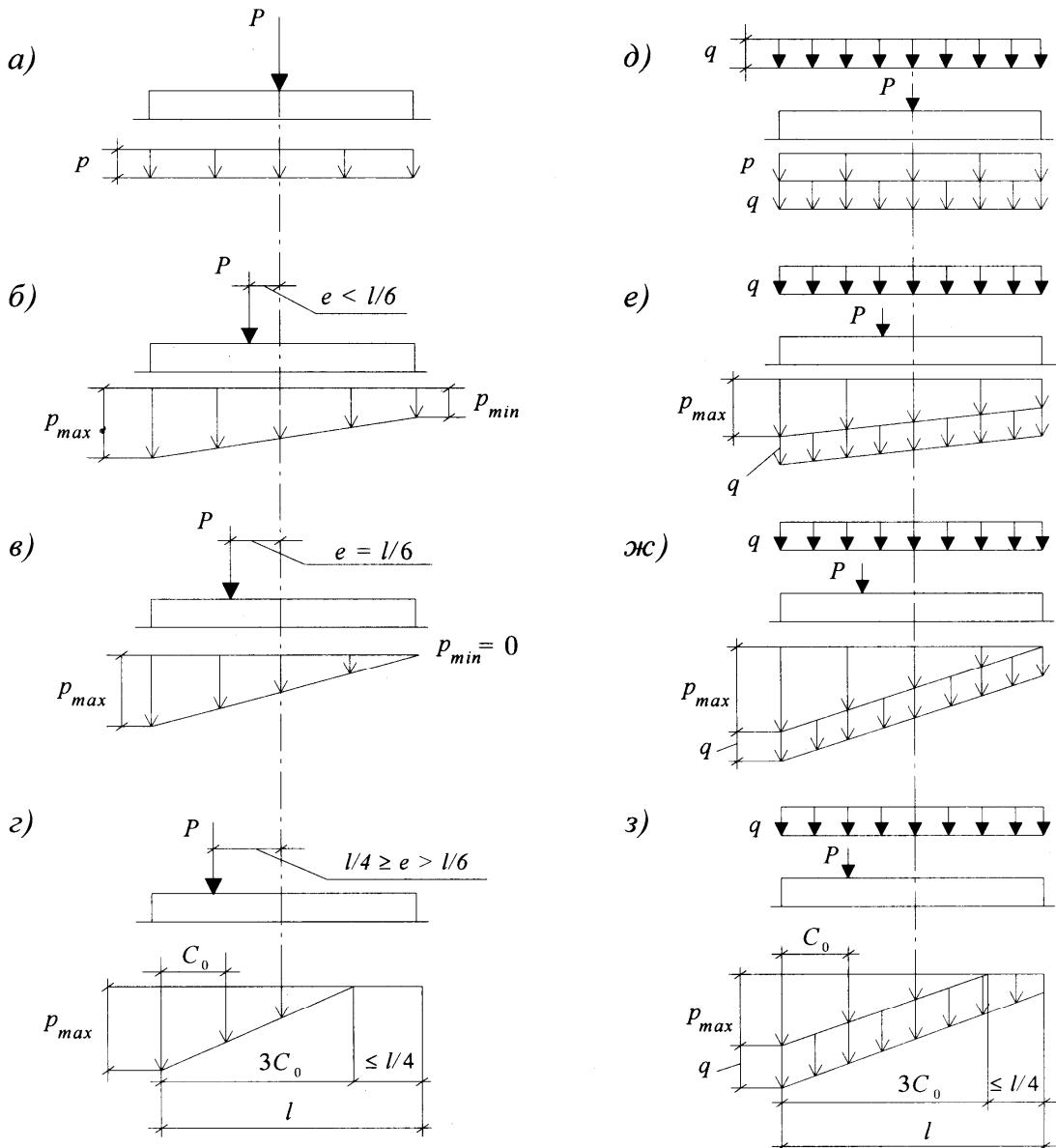
а—е — при отсутствии нагрузок на полы;  $\delta$ —з — при сплошной равномерно распределенной нагрузке интенсивностью  $q$ ; а и  $\delta$  — при центральной нагрузке; б и е — при эксцентрическости нагрузки  $e < l/6$ ; в и ж — при  $e = l/6$ ; г и з — при  $e > l/6$  (с частичным отрывом фундамента от грунта)
