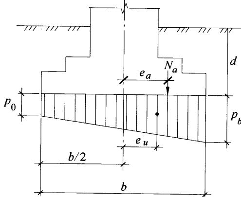
**Рисунок 6.11 — Эпюра предельного давления под подошвой фундамента при сейсмическом воздействии**
